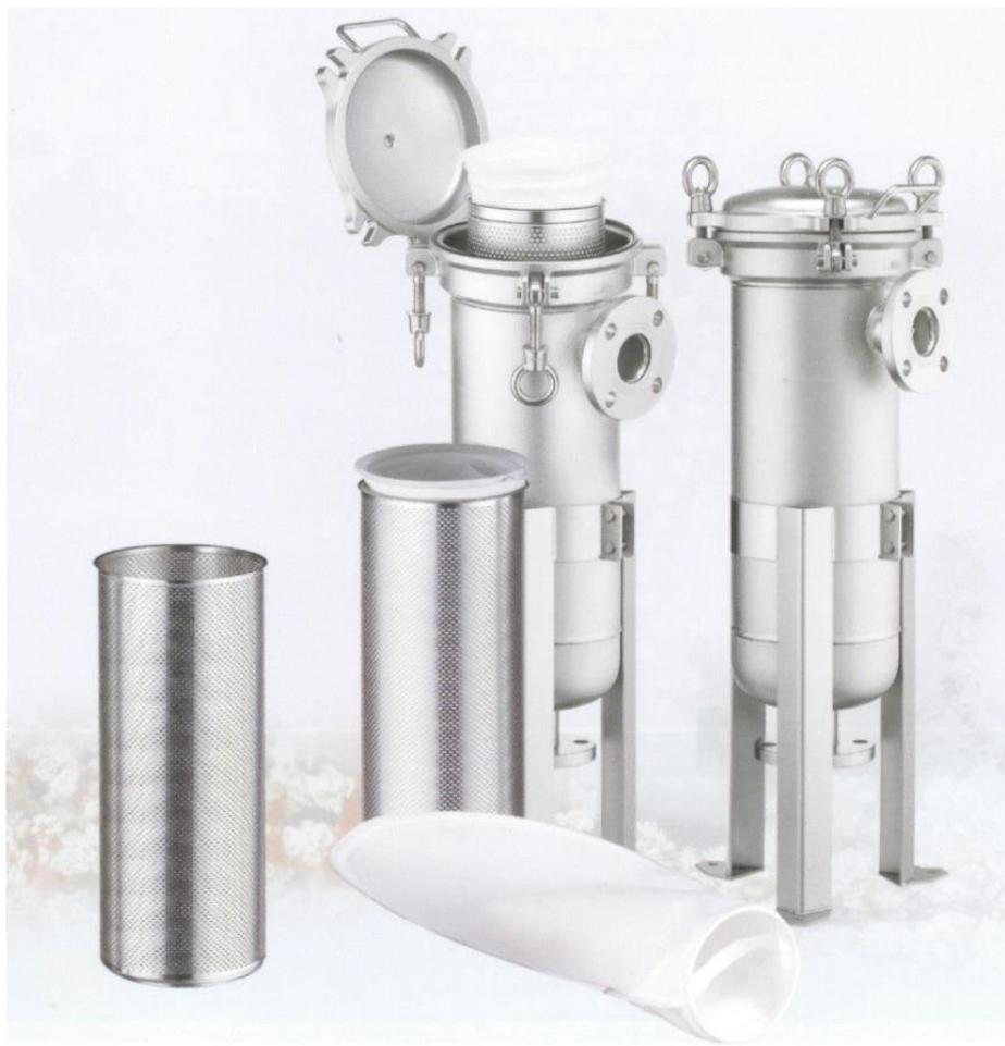
Корпус фильтра изготовлен из высококачественной нержавеющей стали, пригодной для контактирования с питьевой водой. В качестве фильтрующих элементов используются мешочные фильтры различной микронности из полиэстера, полипропилена, нейлона или тефлона.
