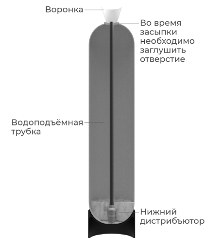
Заполнение фильтра материалом
