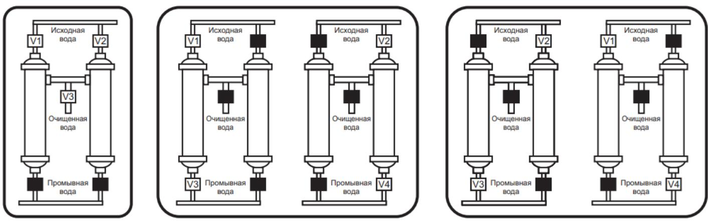
Периодически проводится промывка химическими реагентами, с целью удаления отложений, невымываемых в процессе прямых и обратных промывок. Выбор реагентов и частота промывок зависит от характера загрязнений и качества подаваемой на очистку воды.
