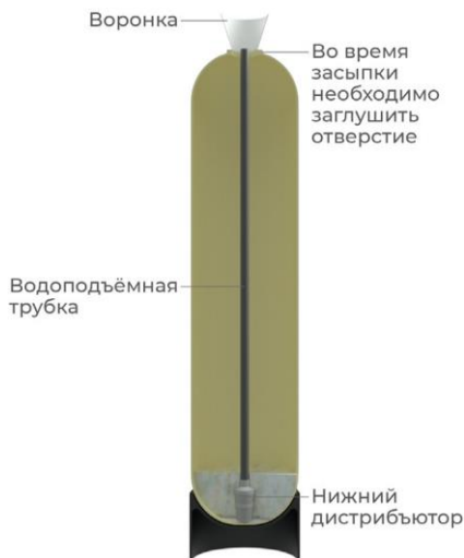
Заполнение фильтра материалом
