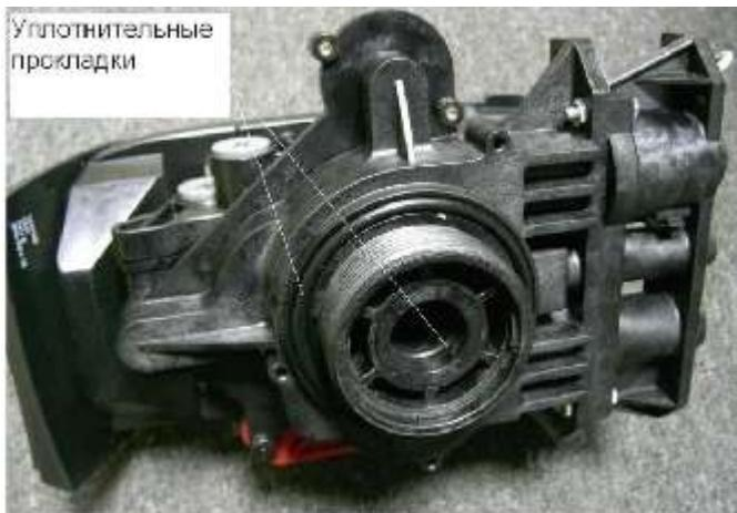
Аккуратно посадить блок управления с верхним защитным экраном на вертикальный коллектор, слегка нажав на блок сверху до исчезновения зазора между горловиной и нижней частью блока
