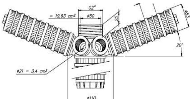
Закрыть верхнее отверстие в водоподъемной трубопроводе сверху плотной пробкой из любого твердого материала так, чтобы ни при каких условиях эта пробка не могла провалиться внутрь корпуса и вертикального коллектора. В противном случае это приведет к полному выходу из строя многоходового клапана блока управления.
