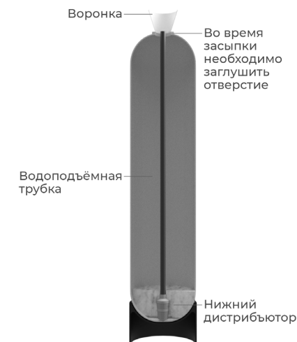
Заполнение фильтра материалом
